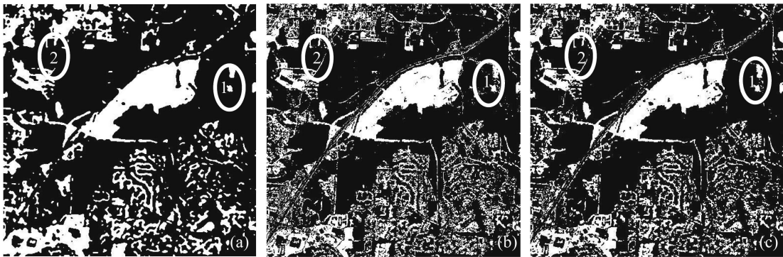
图 9 对于 SPOT 影像的 3 种顾及上下文信息方法的变化检测结果 (a) 概率松弛迭代法; (b) ICM 解算 MRF; (c) SA 解算 MRF
