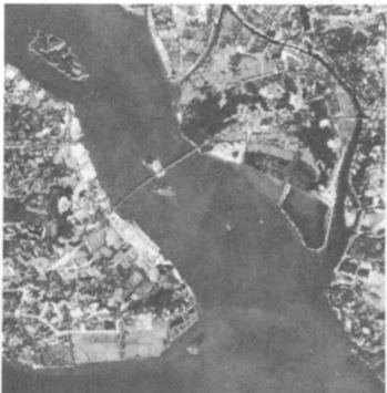
图 7 变化向量分析法所得差分影像 Fig.7 Change vector analysis differential result
