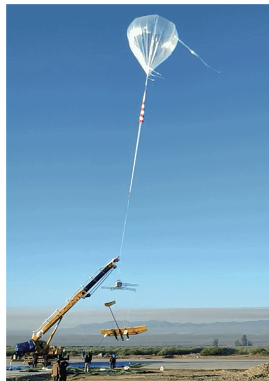
图12 太阳能无人机投放试验
