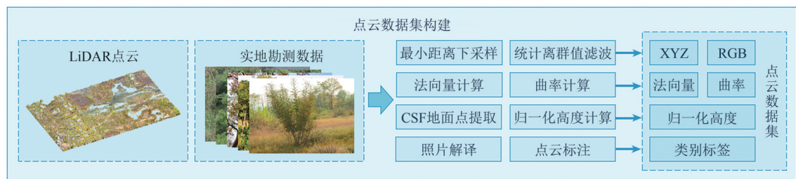
图3 岩溶湿地植被3D点云数据集构建流程
