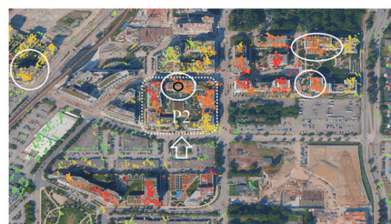
(e) 局部II处SM影像平均形变速率结果
