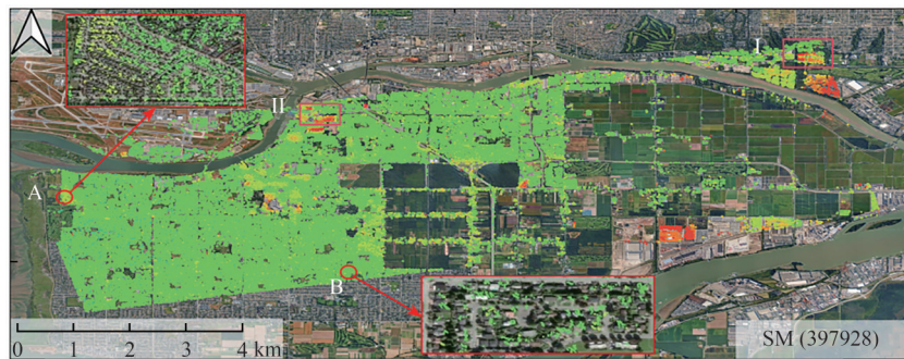
(b) SM影像PSInSAR反演的平均形变速率
