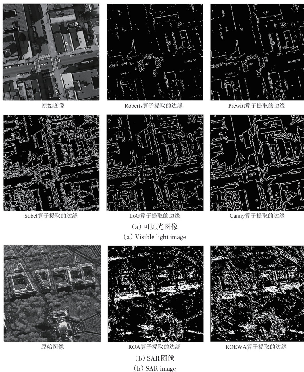
图4 不同边缘检测算子在可见光图像和SAR图像上的可视化对比
