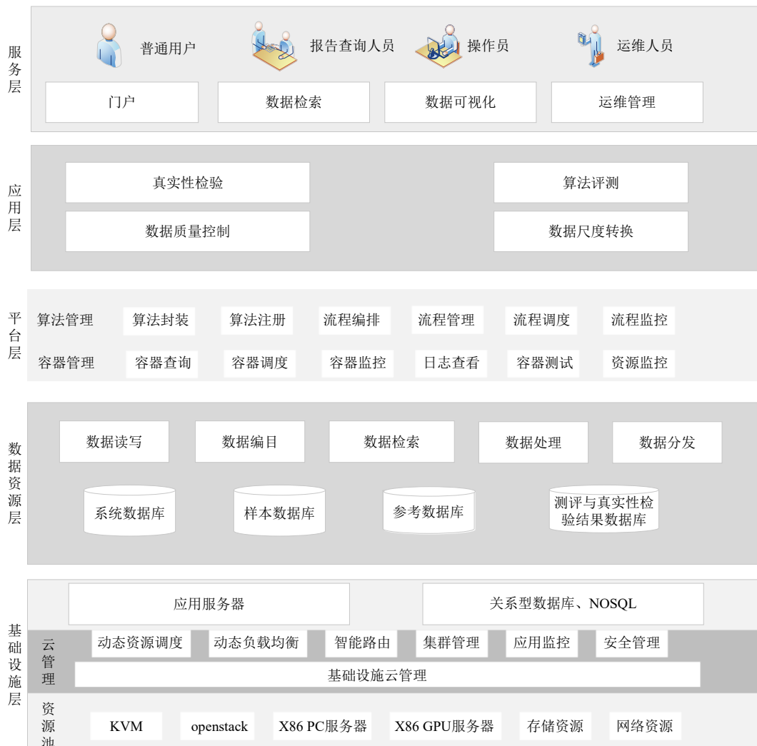
图 4 高分共性产品真实性检验与算法测评架构图
